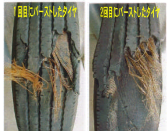
1箇所が裂けている。
